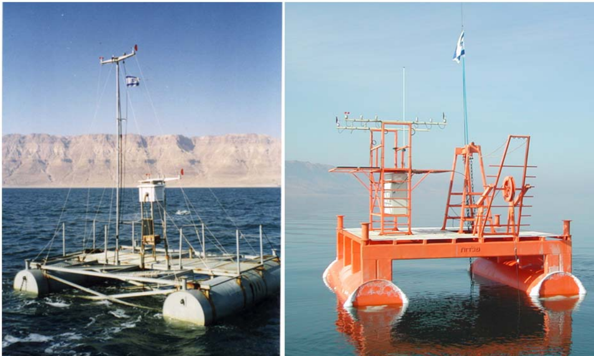
איור 6.1.1. שני דורות של מצופים מטאורולוגיים מעוגנים ב-100-EG (שמאל: דור ראשון בעבודה מיולי 1992 עד לפברואר 2002. ימין: דור שני בעבודה מאוקטובר 2004).
